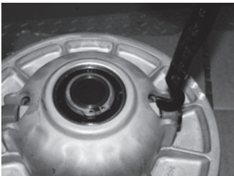
Hakenende des Werkzeugs einführen.
